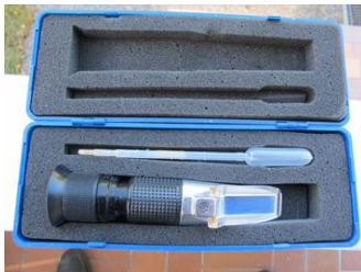
Refraktometer, Avläser honungen i en skala mellan 12 - 27% vattenhalt. Instrumentet och honungen skall ha en temperatur mellan 10 - 30o för att ge korrekta värden. För direktavläsning OBS vi har en elektronisk också.
