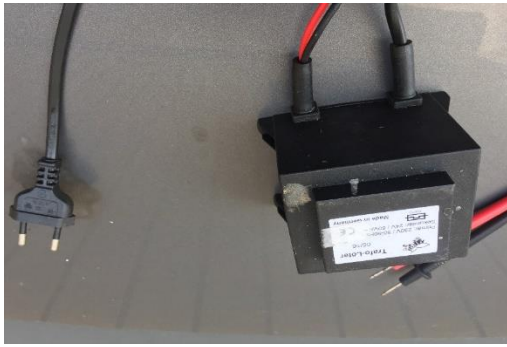
Transformator för insmältning av mellanväggar.
