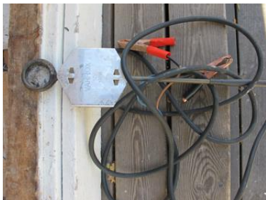
Oxalsyreförångare med tillbehör, batteri, oxalsyra och täckningsutrustning.
